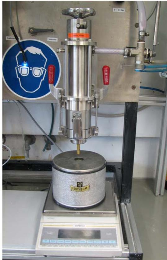
**Abbildung 7: Labornutsche mit Waage und Dewar Auffanggefäß**
