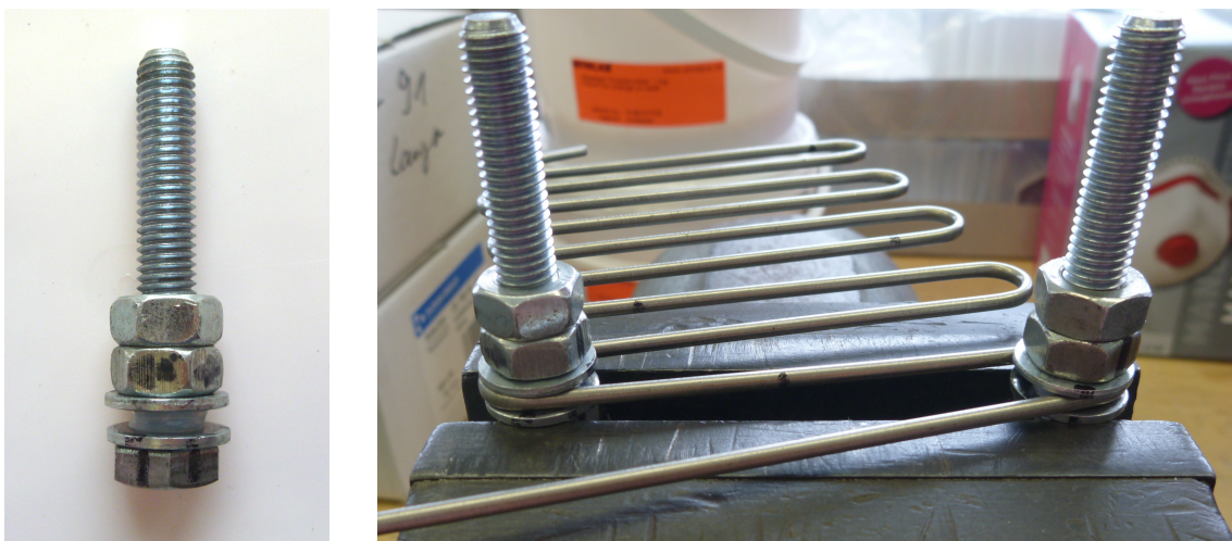
Abb. 4-5: Improvisiertes Biegewerkzeug für dünnwandige Rohre mit geringem Durchmesser, das für den betreffenden Rohrdurchmesser exakt justiert werden kann (links: gemäß Rohrdurchmesser justierbares Biegeelement; rechts: Biegen eines Rohres mit Hilfe von 2 in einem Schraubstock fixierten Biegeelementen)
