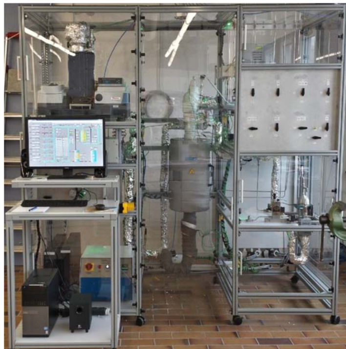
Bild 2-1 Fotografie des Versuchsstandes, rechts: Gasdosiereinheit, mitte: Reaktoreinheit, links: Analytik und Prozesssteuerung
